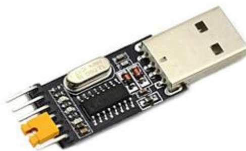
Рис.1 Внешний вид устройства Размер платы 16x51мм
