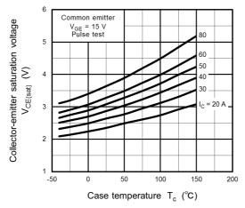
Fig. 8.5 V<sub>CE(sat)</sub> - T<sub>c</sub>
