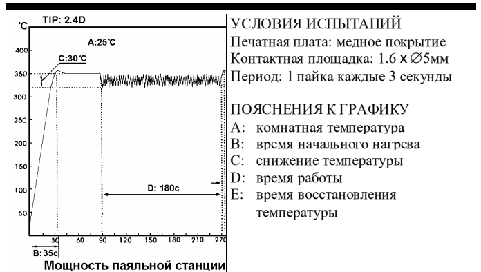
График нагрева и поддержания температуры жала паяльника.
